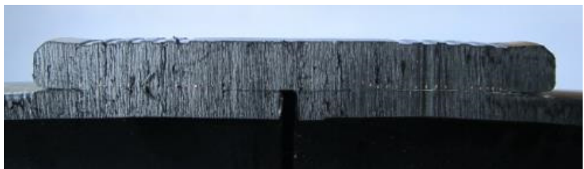
Abbildung 10: Elektromuffen-Schweißung; Rechts: Querschnitt durch die Schweißnaht (Bruckner, 2015).
