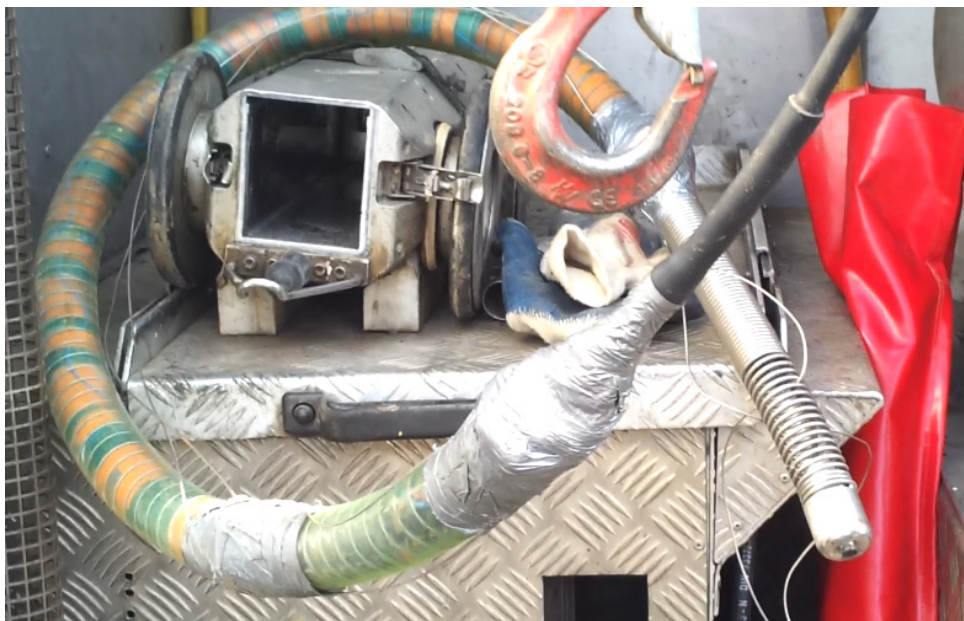
Abbildung 60: Axialkamera vor ihrem Einsatz, verbunden mit dem Stahlseil.
