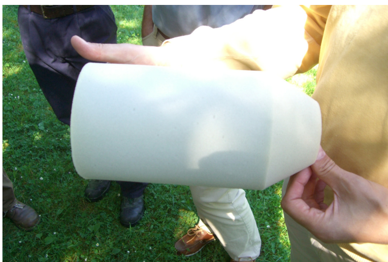
Abbildung 64: Für die Reinigung verwendeter Schaumstoffmolch.
