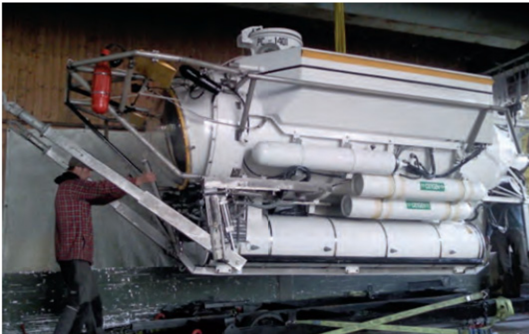
Abbildung 48: U-Boot für eine z.B. äußere Sichtprüfung der Seedruckleitung (Lehnberg, 2012).
