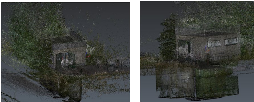
Abbildung 44: Modell der Leica BLK2GO, SBW AWV Schwechat (Geo4You, 2021)
