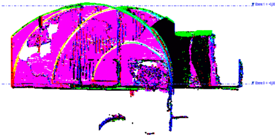
Abbildung 79: horizontal ausgerichtete Punktwolke in Autodesk Revit®
